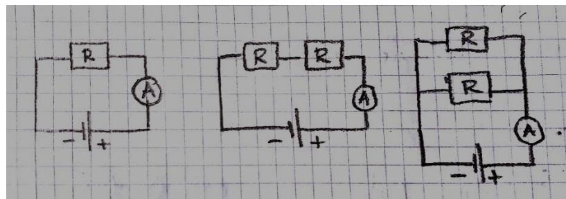
26. Izračunaj ukupni otpor otpornika u svakom strujnom krugu!
