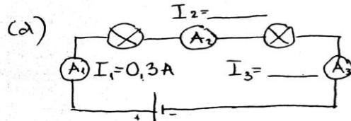
2) U strujnom krugu na slici obje su žaruljice jednake. Ampermeter  $A_1$  pokazuje jakost struje  $0,5A$ . Koliki naboј prođe žaruljicom 2 u jednoj minuti?
